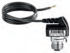
161 Pressóstato com cabo para cablagem. Campo de funcionamento: 0,5–10 bar. Temperatura máx.: 100 °C. Comprimento do cabo: 1 m.
